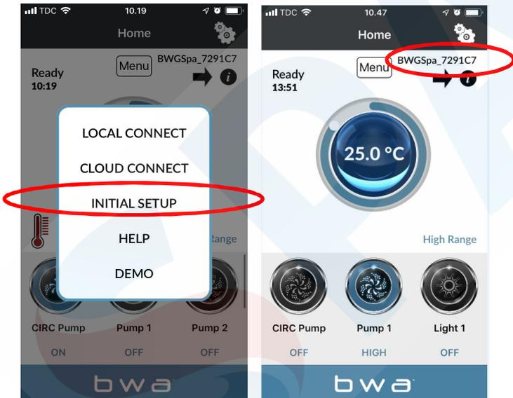
O segundo passo é ligar o seu módulo wifi ao seu router wifi local na configuração da aplicação bwa através do ícone de configuração. Tem de ser 2,4GHz e não 5GHz. Deve permanecer perto do seu spa e ter uma boa cobertura wifi. Introduza o nome da rede e a palavra-passe e prima para baixo. O ajuste está definido para WPA. Poderá ter de escolher WEP; WPS; OPEN, dependendo do seu router.
